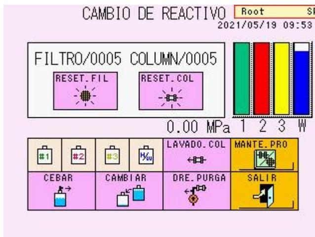
4. Se mostrará el siguiente mensaje para solicitar que se abra la válvula de drenaje (pantalla 5-12). Abra la puerta situada en el lateral izquierdo del analizador y gire la válvula de drenaje 90 grados hacia la izquierda para abrir la válvula. No gire la válvula más de 90 grados.
