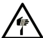
No coloque los dedos ni ningún otro objeto dentro de la zona de toma de muestras del cargador. El movimiento descendente de la aguja de muestras puede provocar lesiones.
